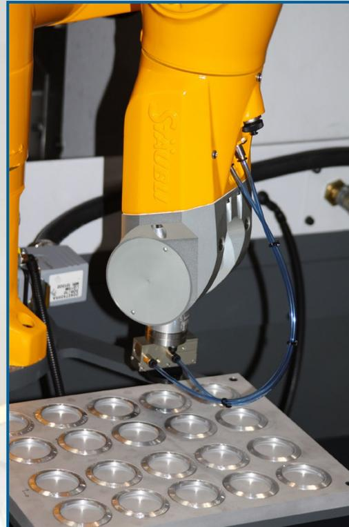
La mise en place de ce système permet à la machine d'**usiner en continu** jusqu'à 20 pièces, sans intervention de l'opérateur.
