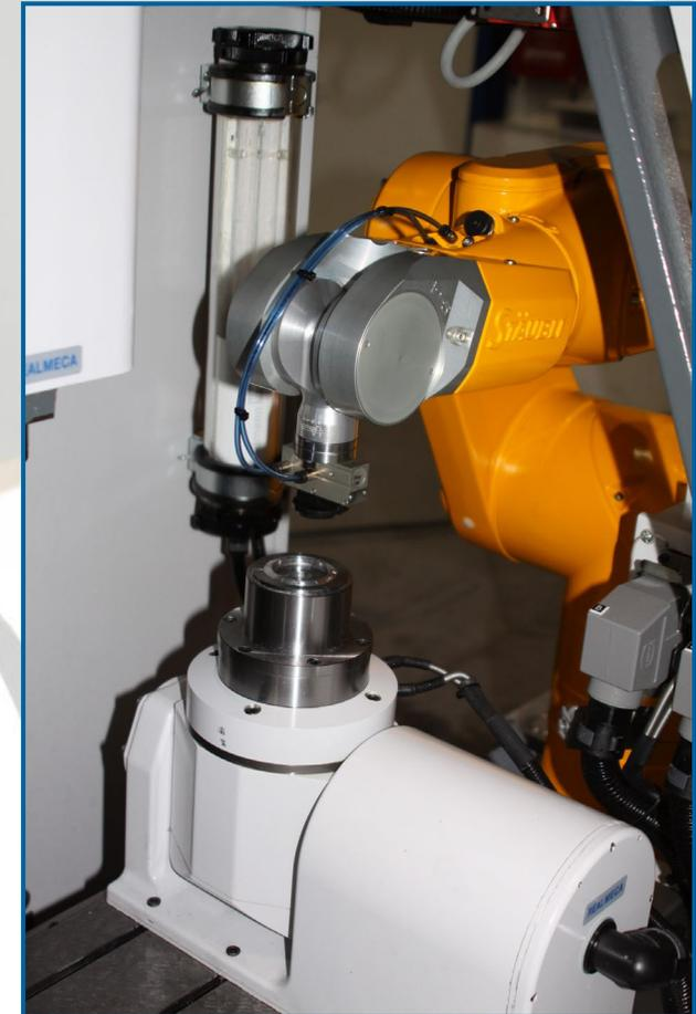
Le bras robotisé est installé sur le côté gauche de la machine et est placé sur un support surélevé, fixé au bâti de la machine.
