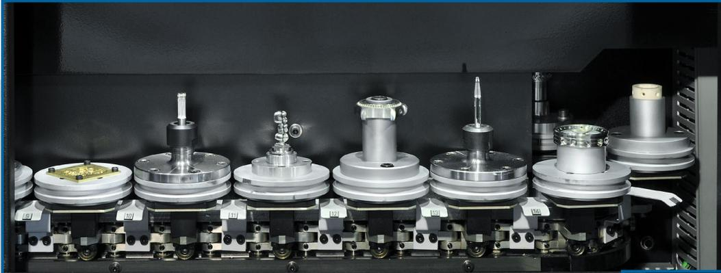
Grâce à ce système de palettes, il est possible de travailler sur **30 pièces différentes à la fois**.
